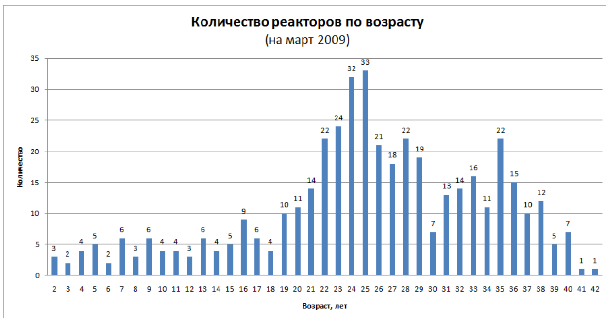
Рис. 2. Реакторы по возрасту, включая находящиеся в стадии модернизации Источник информации [8].
